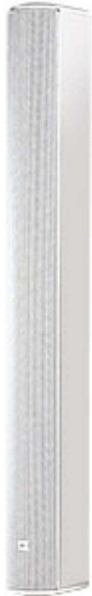
Gli altoparlanti scelti sono le JBL CBT 100LA (Line Array Column Loudspeaker with Sixteen 50 mm Drivers). Abbiamo effettuato questa scelta per la loro efficienza nel riprodurre il parlato, per lo stretto angolo di diffusione verticale (che è utile per non far lavorare la cupola in maniera negativa per il campo acustico) e per la facilità di inclinazione e montaggio.
