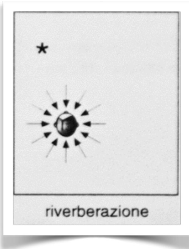
in ogni riflessione l'intensità del suono viene ridotta di un fattore  $x < 1$ , dopo  $N$  riflessioni risulterà ridotta di un fattore  $x^N$ :
