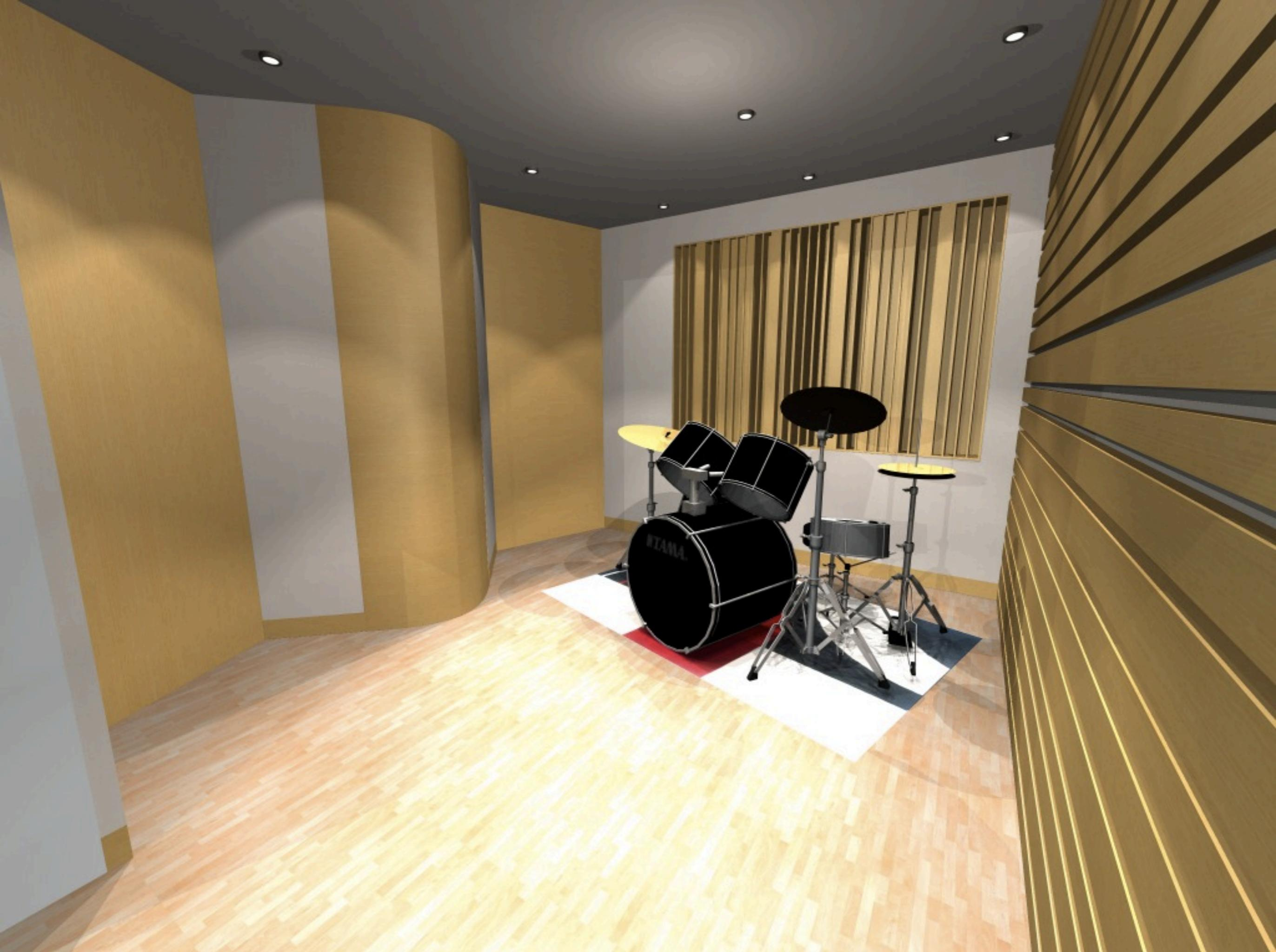
dispositivi di assorbimento: fibra poliestere incassata in telai di legno e sopra stoffa ignifuga tesata.
