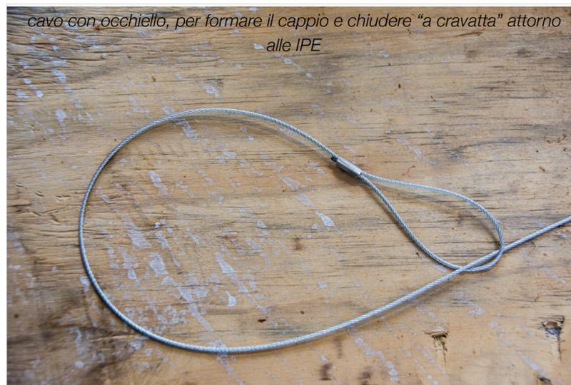
*cavo con occhiello, per formare il cappio e chiudere "a cravatta" attorno alle IPE*
